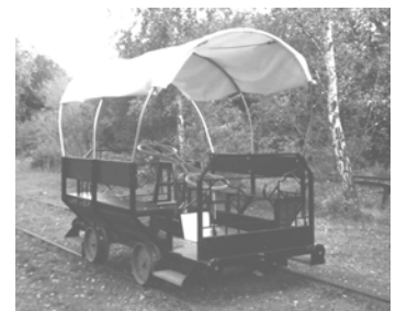
Abb. 7: moderne Handhebeldraisine (eigene Aufnahme)
