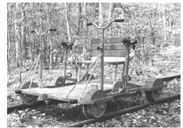
Abb. 6: moderne Handhebeldraisine (eigene Aufnahme)
